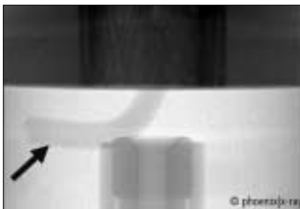
Bild 1: Mikrofokus-Röntgenbild eines HF-Koaxial-Steckverbinders. Bei der Montage hat der Mittelleiter das Aufnahme Loch im Mittelkontakt des Steckers verfehlt. Eine elektrische Unterbrechung war nicht nachzuweisen. Oben im Bild der Außenkontakt mit der Kabelabschirmung
