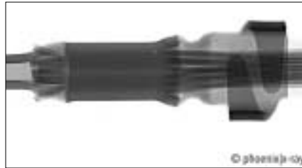
Bild 3: Mikrofokus-Röntgenbild der Crimpverbindung eines Kabels mit 19 Einzellitzen, Gesamtquerschnitt 0,75 mm 2 . Die Einzellitzen sind durch Überlagerung nicht mehr zu unterscheiden. Der Kabelstrang läuft von rechts ein
